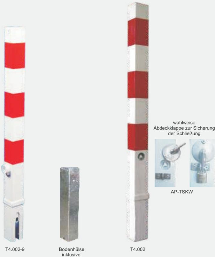
Den herausnehmbaren Feuerwehroposten fertigen wir in 1000 mm und 900 mm Längen über Flur. Die Entriegelung erfolgt durch Feuerwehr - Dreikant nach DIN 3223. Die DIN-Schlüssel gehören nicht zum Lieferumfang und müssen separat bestellt werden. (siehe Zubehör)
